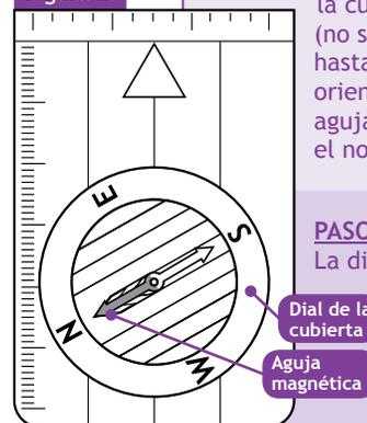
**PASO 3:** gire el dial de la cubierta de la brújula (no su cuerpo ni la brújula) hasta que la flecha de orientación se alinee con la aguja magnética que indica el norte verdadero (Figura 2).
